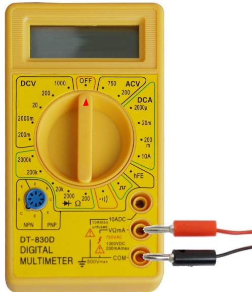
Figura 3: Fotografía de un multímetro indicando la conexión de las puntas de los caimanes.
