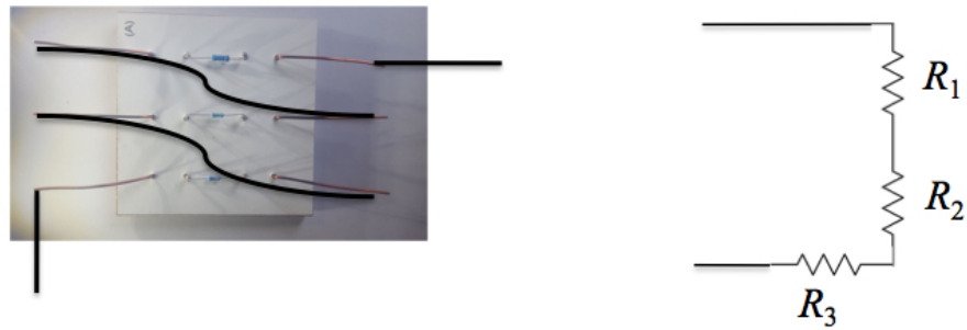
Figura 13: Circuito 11. R_1 , R_2 y R_3 en serie. R_C = 24.8 \text{ k}\Omega .
