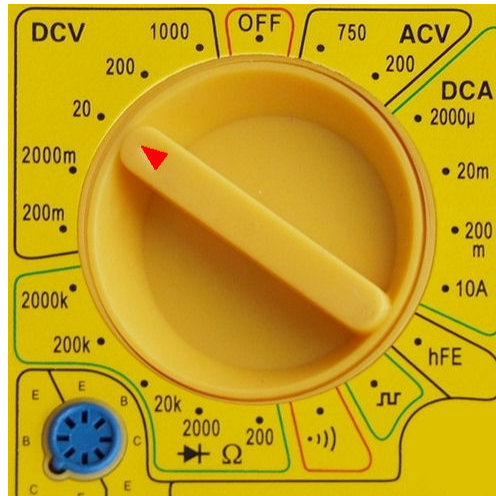
Figura 5: Posición para medir voltaje hasta de 20 V DC.
