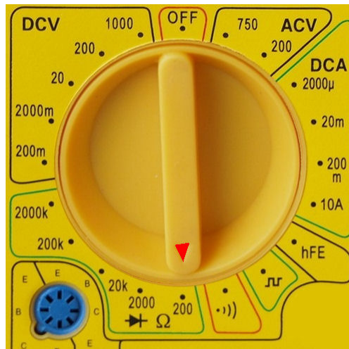
Figura 6: Posición de menor resistencia (200 \Omega ).
