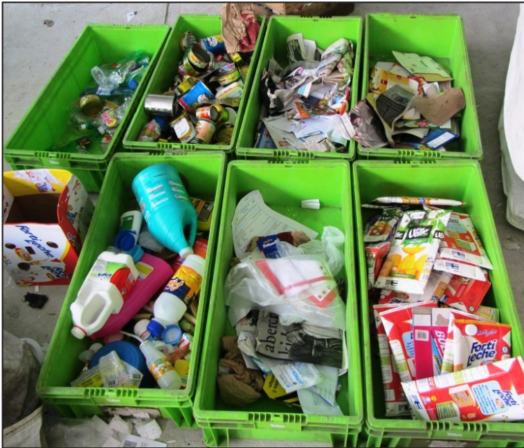
Figura 3.3. La separación de los residuos es un paso fundamental donde los residuos recolectados son separados con base en sus características fisicoquímicas, para su posterior utilización, reduciendo la cantidad de desechos que se derivan a los rellenos sanitarios, creando nuevas fuentes de trabajo y volviendo al sistema de producción para ser utilizados como materia prima. En la figura se muestra el proceso de separación de residuos sólidos llevada a cabo en las instalaciones de la Unidad Universitaria de Acopio de Residuos (UUAR) de la UAEM. Fotografía: Horacio Terrazas Hoyos.
