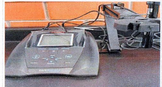
F2: Laboratorio de química analítica-lq4) Edificio 35 equipado con medidor de mesa para conductividad 1 pieza.
