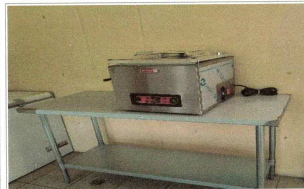
Empacadora al alto vacío para el laboratorio de alimentos de la Facultad de Agropecuarias
