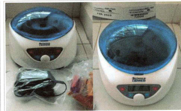
Centrífuga Clínica para 6 tubos. Intervalo de velocidad: 300 - 5000 rpm Precisión: \pm 20 rpm RFC máxima: 2600 xg Capacidad del rotor: 6 tubos de 15 para laboratorio B01 (Edificio 61) en la Facultad de Farmacia.
