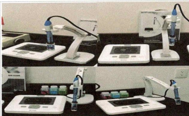
Medidor de pH y mV de mesa, incluye electrodo, intervalo de medición: 0.00 - 14.00pH; Precisión: \pm 0.01 pH Puntos de calibración: 2 puntos para el Laboratorio - Planta Piloto (Edificio 61) en la Facultad de Farmacia.
