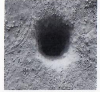
F77: Pruebas de laboratorio para compactación de material mejorado en planta baja.
